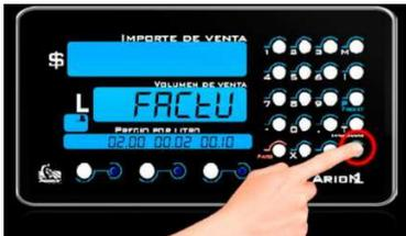
Esto se lleva a cabo pulsando 1 vez la tecla Menú (M) y presionando enter (verde). Dependiendo del modo en el que se realizó el surtido (mediante cliente u operador).
