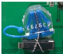
Sello de seguridad cuando está presionado des-habilita la herramienta de calibración, se controla con un numero impreso en el sello y registrado en el proceso de pruebas
