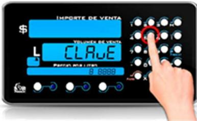
En esta pantalla se puede visualizar el valor actual de este parámetro, y se puede realizar la modificación este valor; se debe presionar la tecla enter y el dispensador pedirá que se introduzca la contraseña que tiene almacenada el equipo,
