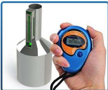
El sistema requiere una preparación (ambientación) con la finalidad de asegurar que se encuentra llena la manguera, la jarra esté húmeda y cerca de la temperatura del combustible.
