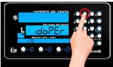
Identifique el operador, tecleando su Id mediante teclado o mediante TAG.
