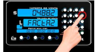
Factor de calibración Producto 3: Muestra en pantalla el Factor de Calibración del Producto 3 del dispensador.
