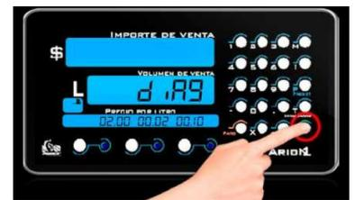
Factor de calibración Producto 1: Muestra en pantalla el Factor de Calibración del Producto 1 del dispensador.
