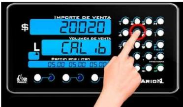
Introduzca con las teclas numéricas el volumen registrado por la jarra patrón en mililitros (ejemplo: si la jarra marca -20ml se debe introducir 19980, otro ejemplo si la jarra marca +20ml se debe introducir 20020) y pulse la tecla enter (verde), al hacer esto el equipo se calibrará sólo.
