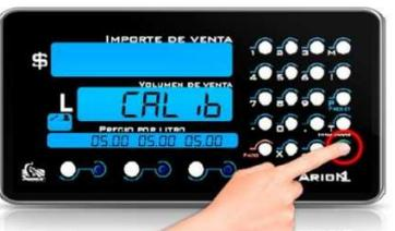
Pulse la clave, de fábrica el equipo sale con la clave (12345678), y pulse enter.
